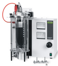
Encapsulator B-395 Pro 温和、无菌的微球和微胶囊颗粒制造
