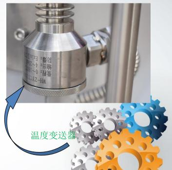
\*图为压力/温度保护装置,通常我们研磨生产时由于物料与锆珠的摩擦、碰击会产生较高温度,过高会使物料起反应,发生结皮、变色等现象,通过PLC控制的温度变送器能把温度变化信息
