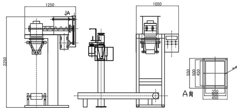
DCS-50F定量包装机是我公司自主研制开发的，又有自主知识产权的新型高性能的包装秤，适用于面粉、淀粉、饲料以及食品、化工、轻工、医药等行业粉状的自动定量包装设备。
